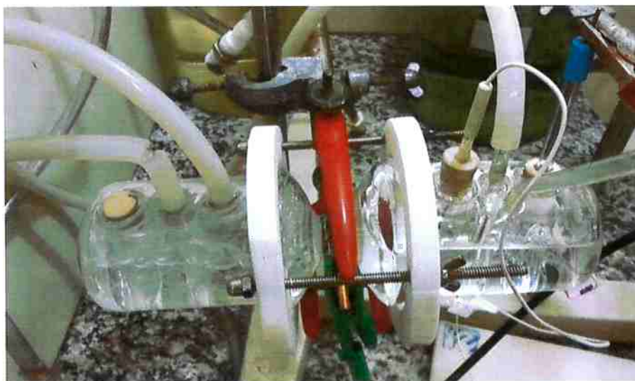
Figura 10 - Célula de permeabilidade de hidrogênio durante o ensaio.
