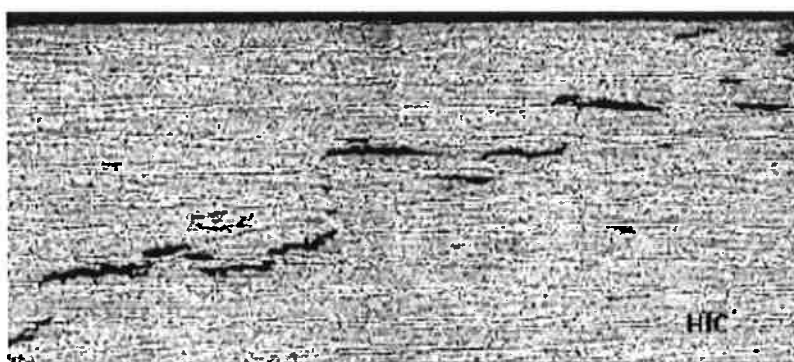
Figura 2 - Trinca induzida por hidrogênio (Leandro, 2009).
