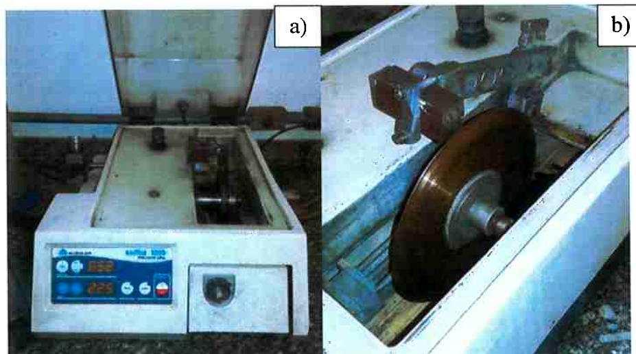
Figura 5 - a) Isomet 1000 da Buehler, modelo Precision Saw. b) Amostra sendo cortada com a espessura de 1,0 mm.
